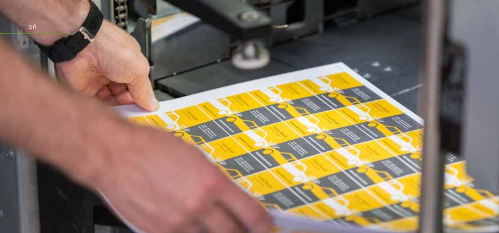
Die Druckbogen werden mit dem Duplo DokuCutter DC-645 automatisch auf das Endformat geschnitten und perforiert.
